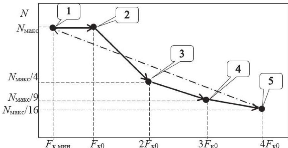
Рис. 3. Состояние 1 – низкая кадровая частота, высокая четкость; состояние 2 – максимальная кадровая частота  $F_{k0}$  при полной четкости; состояние 3 – повышенная в 2 раза кадровая частота; состояние 4 – повышенная в 3 раза кадровая частота; состояние 5 – повышенная в 4 раза кадровая частота; пунктир – переход системы в исходное состояние по завершениистыковки КА
