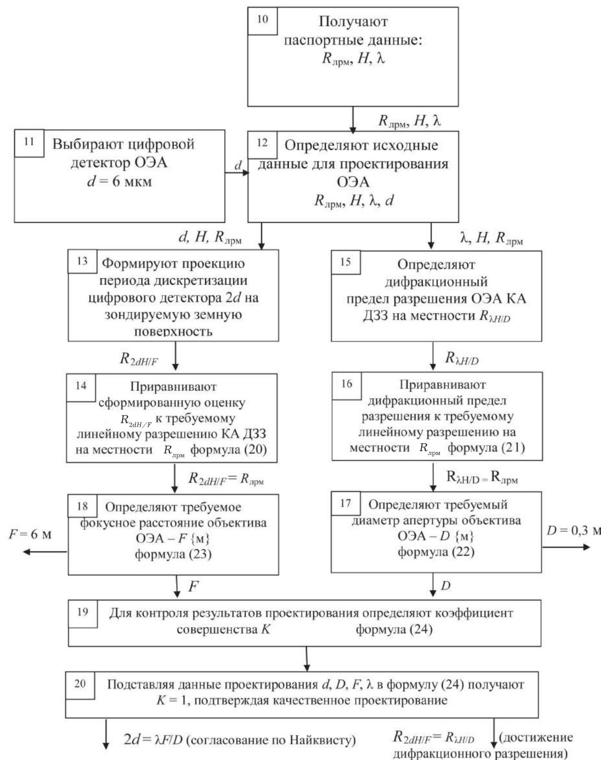
Рис. 4 Блок-схема реализации процесса проектирования ОЭА КА ДЗЗ, используя критерий оценки предельного инструментального разрешения КА ДЗЗ на местности – РКС ( $R_{2dH/F}$ )
