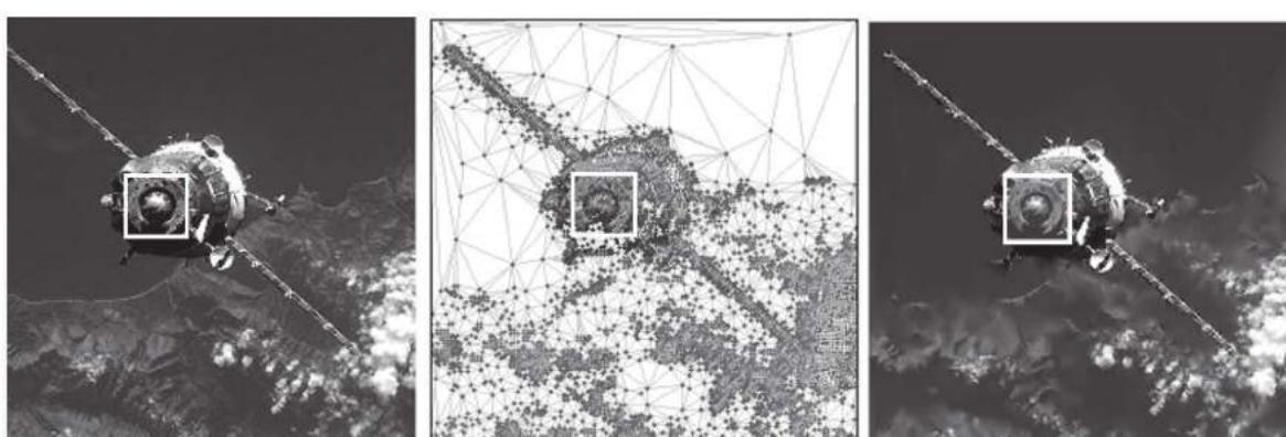
Рис. 5. Пример кодирования и декодирования изображения по опорным точкам с различными порогами для объекта и фона; порог выделения опорных точек в окне интереса  $\gamma_o = 13$ , вне окна  $\gamma_\phi = 98$ , передаваемая информация в окне  $R_o = 4,2$  бит/пикセル, вне окна  $R_\phi = 0,8$  бит/пикセル
