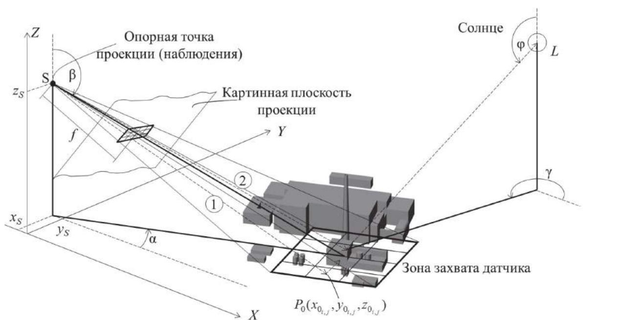
Рис. 1. Геометрическая интерпретация механизма трассировки лучами трехмерной ЦММ (объекта) при формировании прогнозных изображений местности в видимом диапазоне
