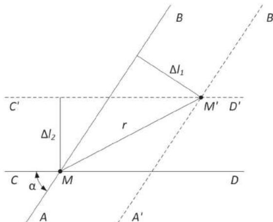
Рис. 1. Радиальная погрешность определения местоположения источника излучения на плоскости
