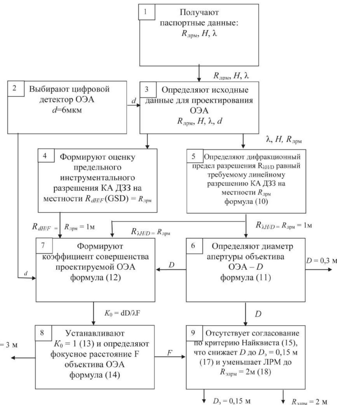
Рис. 3 Блок-схема реализации процесса проектирования ОЭА КА ДЗ3, используя критерий оценки предельного инструментального разрешения КА ДЗ3 на местности – GSD ( $R_{dH/F}$ )
