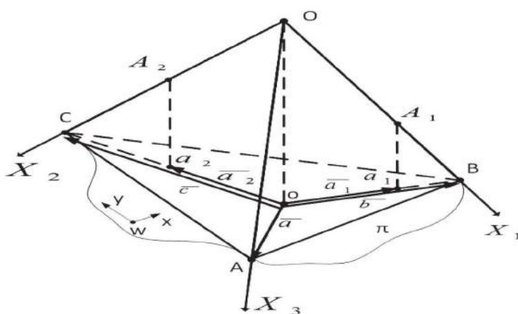
Рис. 4. Пространственная система координат и её проекция
