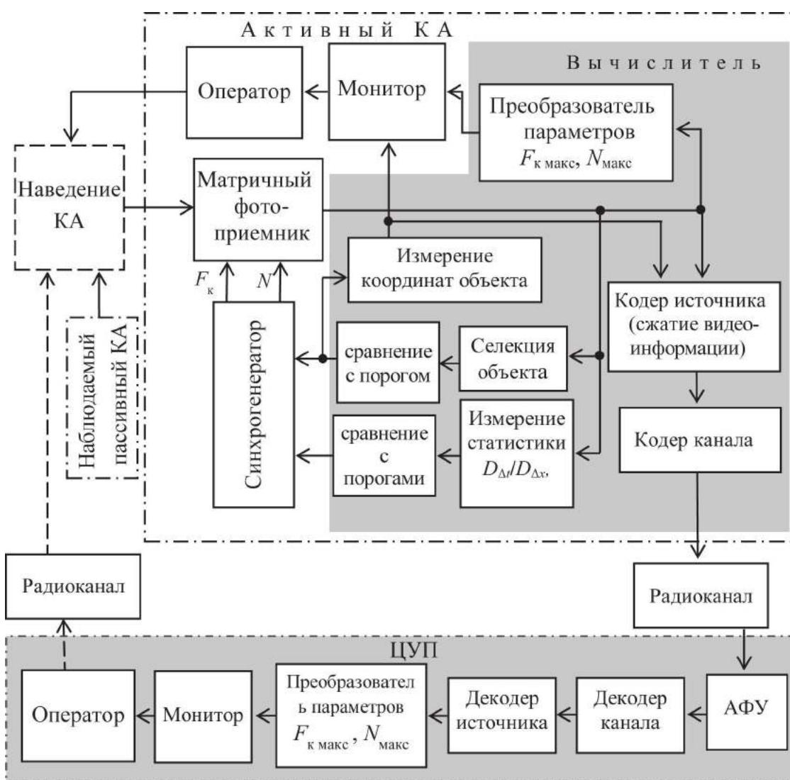
Рис. 1. Структура видеоинформационной системы контроля сближения КА
