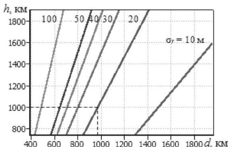
Рис. 4. Линии равных погрешностей определения местоположения ИРИ
