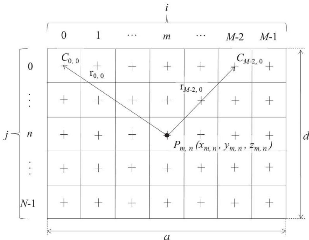
Рис. 2. Пример матрицы ПЗС размером  $M \times N$  элементов
