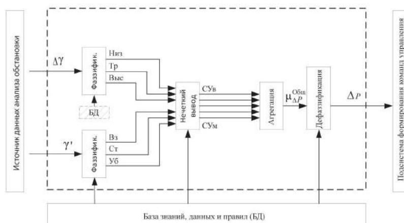
Рис. 6. Схема принятия решения по коррекции мощности передатчика
