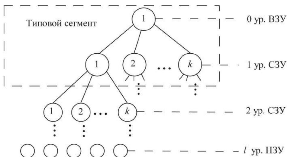
Рис. 1. Топология радиосети иерархической структуры
