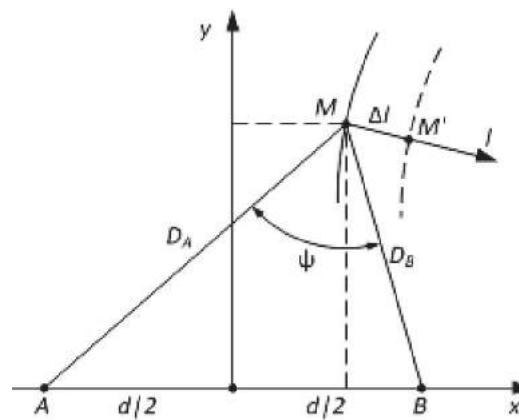
Рис. 2. Погрешность определения линии положения на плоскости
