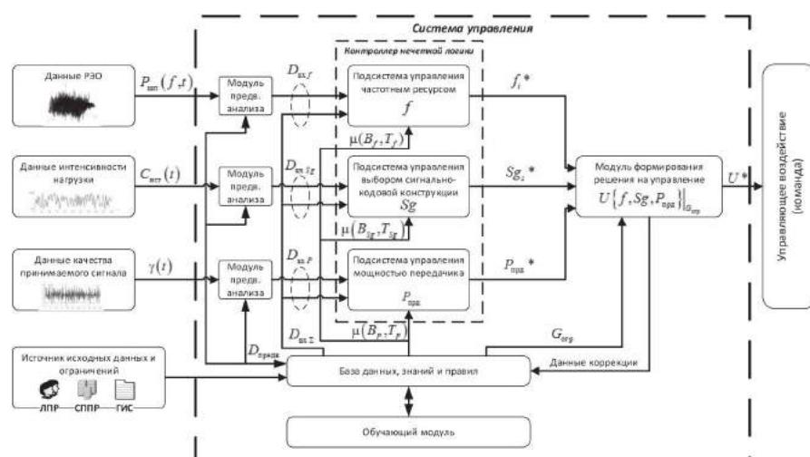
Рис. 3. Структурная модель системы управления когнитивной радиосистемы на основе нечеткой логики
