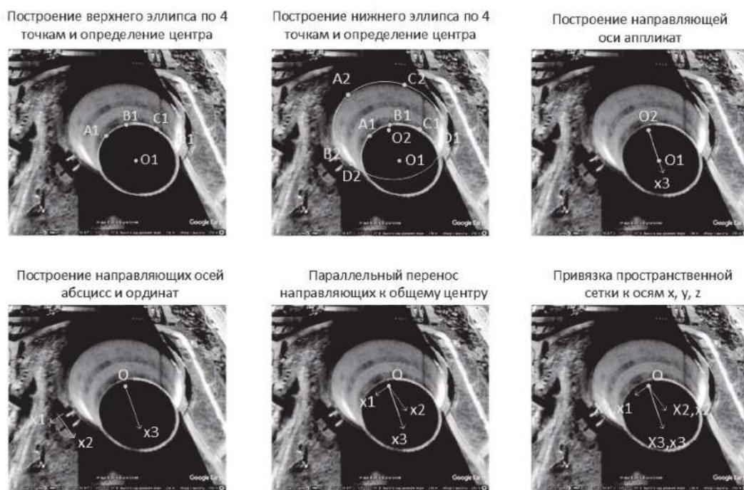
Рис. 6. Геометрические построения для получения образа пространственной декартовой системы координат (на примере тепловых башен)
