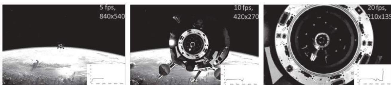
Рис. 4. Выборочные кадры из видеофильма, сформированного с помощью системы с взаимообменом кадровой частотой и числа пикселов, адаптирующейся к изменению решашющей статистики отношения межкадровых и межэлементных приращений по мере приближения КА
