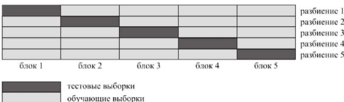
Рис. 4. Разбиение данных при 5-блочной кросс-валидации
