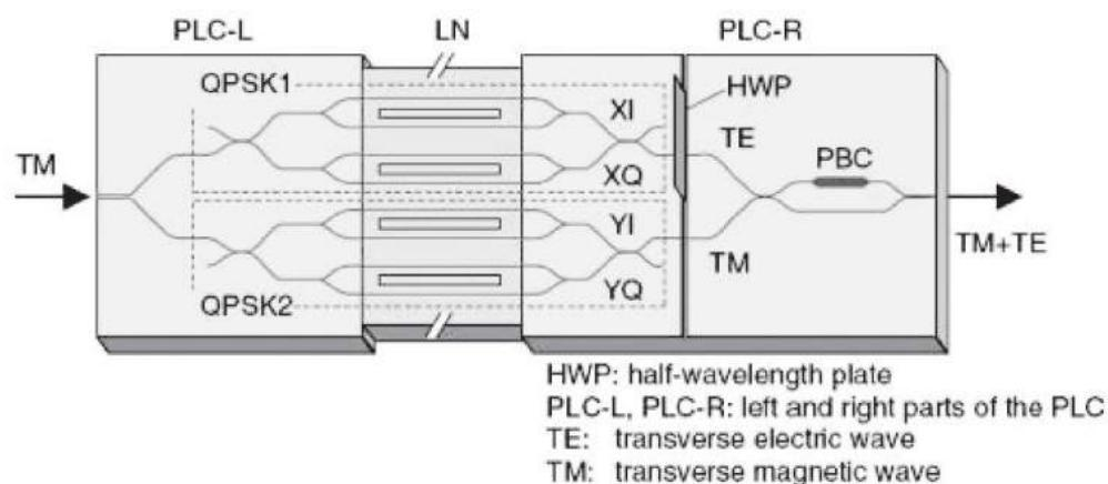
Рис. 6. Модулятор QPSK
