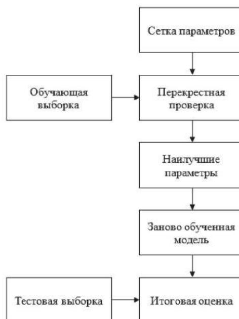
Рис. 3. Процесс отбора параметров и оценки модели
