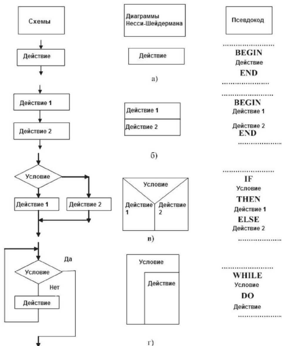
Рис. 1. Базовые операторы структурного программирования: а) действия; б) последовательность; в) выбор; г) итерация
