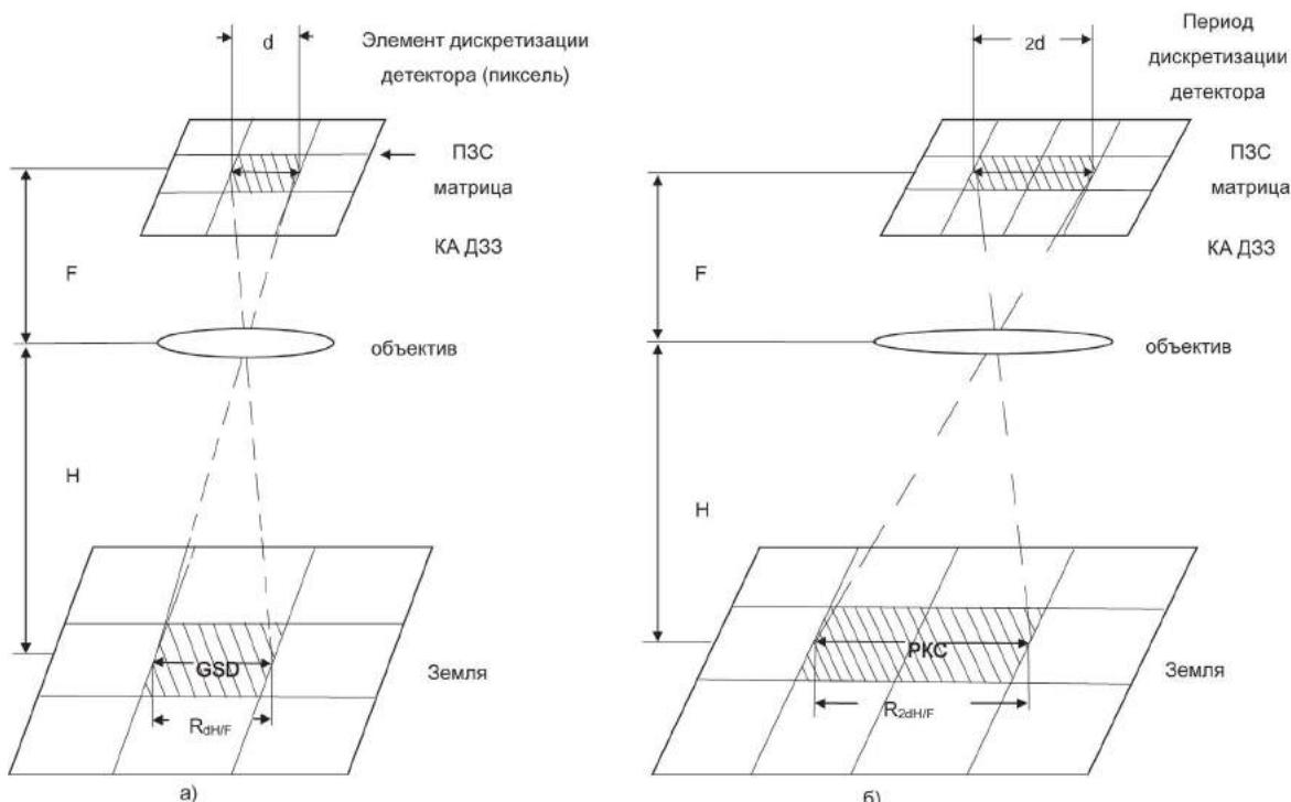
Рис. 2. Оценка предельного инструментального разрешения ОЭА КА ДЗЗ на местности:
