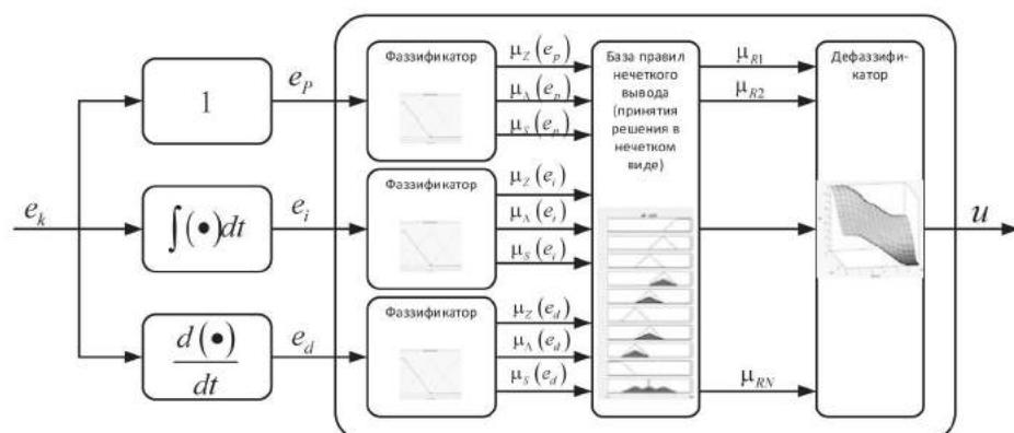
Рис. 2. Обобщенная структурная схема пропорционально-дифференциальнно-интегрального контроллера нечеткой логики (НПИД)
