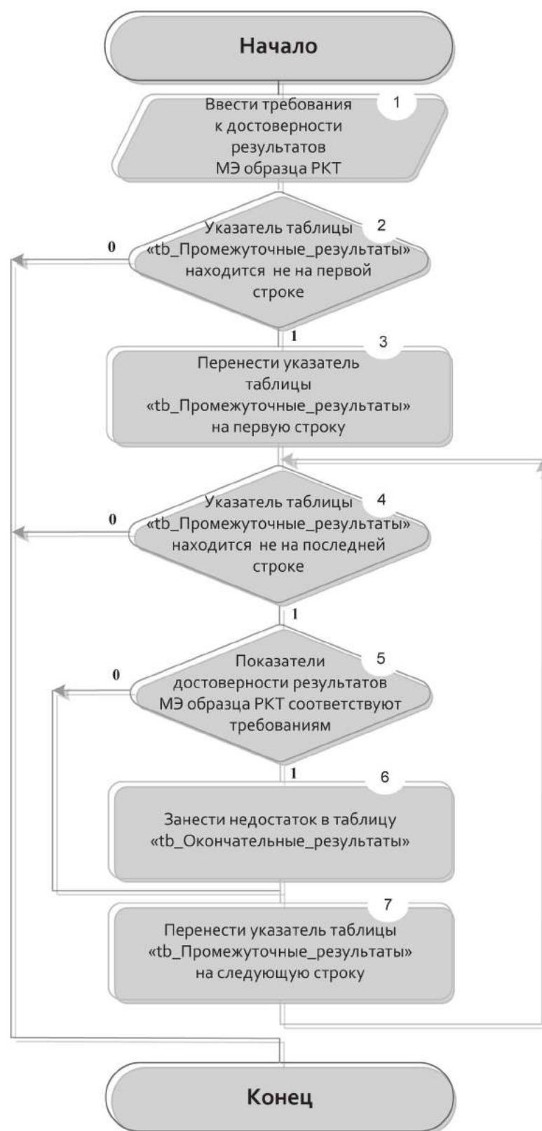
Рис. 4. Схема алгоритма оценивания и выбора достоверных результатов МЭ образца РКТ
