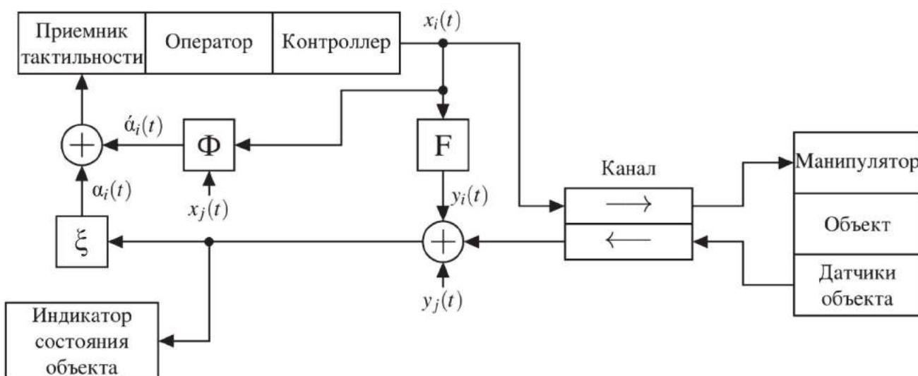
Рис. 1. Обобщенная модель Haptic-кодека как параметрической системы регулирования
