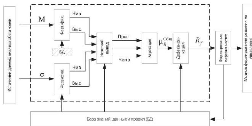
Рис. 4. Схема принятия решения по управлению частотой (присвоение рейтинга)
