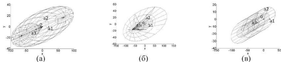
Рис. 10. Примеры нелинейных сеток: а) коническая; б) цилиндрическая; в) эллиптическая (программные модели)
