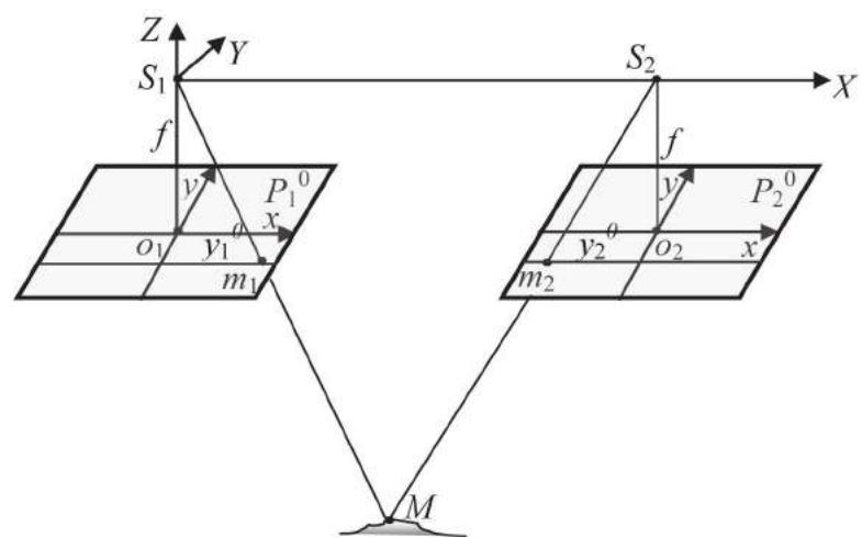
Рис. 2. Идеальная стереопара снимков
