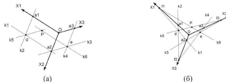
Рис. 7. Прямоугольная сетка: а) ортотрансформированная; б) перспективная
