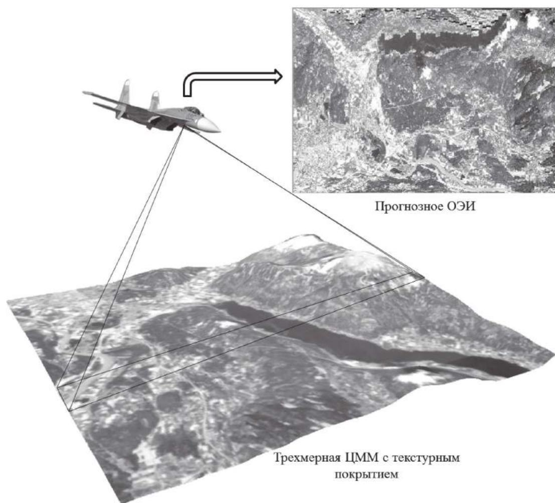
Рис. 5. Результат формирования прогнозного изображения оптико-электронного датчика сканерного типа при наблюдении земной поверхности с сильно выраженным рельефом с высоты 300 м
