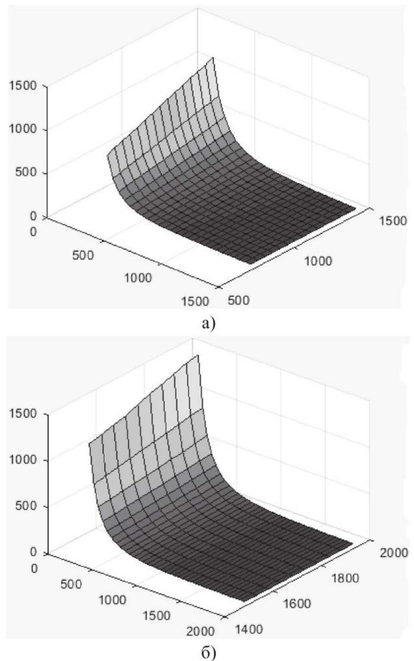
Рис. 3. Зависимость погрешности  $\sigma_r$  оценивания местоположения ИРИ от размера базы  $d$  и высоты  $h$  орбиты группировки КА а) высота орбиты от 750 км до 1500 км; б) высота орбиты от 1500 км до 2000 км
