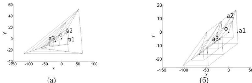
Рис. 11. Примеры линейных сеток: а) пирамидалная; б) призматическая
