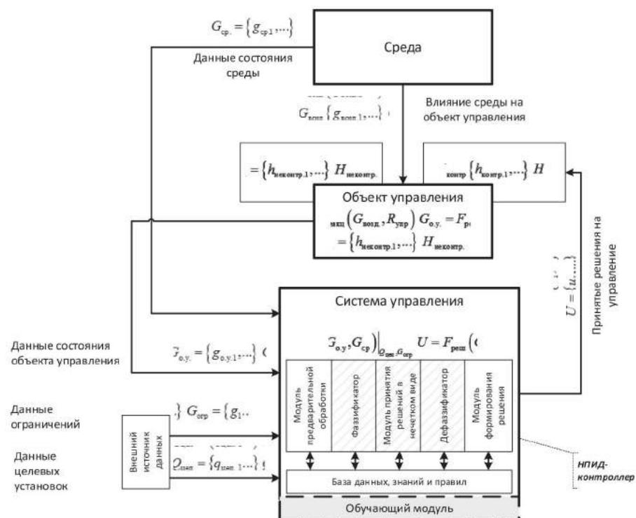
Рис. 1. Обобщенная структурная модель когнитивной радиосистемы на основе нечеткой логики
