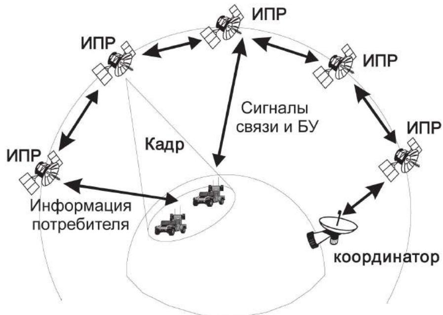
Рис. 1. Схема информационных потоков ОСКА
