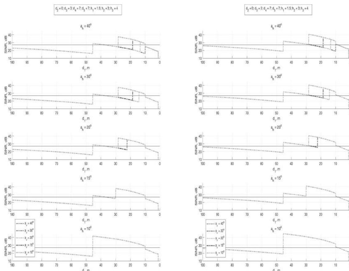
Рис. 2. Сценарий 1: механическое (слева) и электронное (справа) управление лучом
