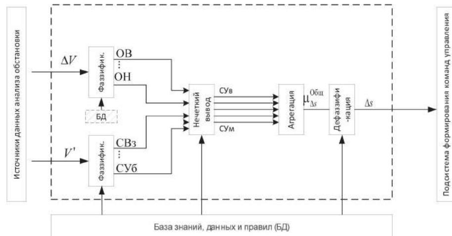
Рис. 5. Схема принятия решения на изменение индекса сигнально-кодовой конструкции
