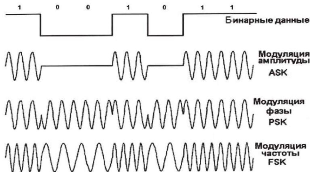
Рис. 10. Примеры форматов оптической модуляции
