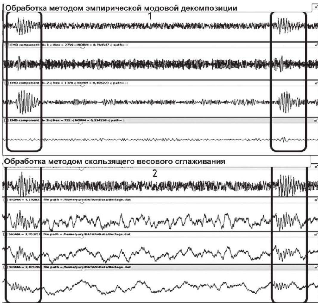
Рис. 2. Отображение результата сравнения применения ЭМД и процедуры взвешенного усреднения к аддитивной смеси пары импульсов Берлаге и шума
