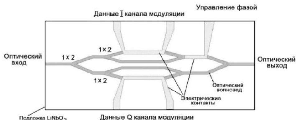
Рис. 5. Логическая структура внешнего модулятора передатчика когерентных систем
