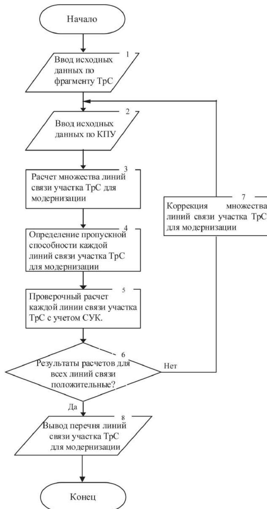
Рис. 1. Блок-схема принятия решения на модернизацию участка ТрС методом наложения
