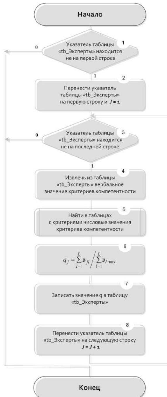
Рис. 2. Схема алгоритма определения коэффициента компетентности каждого метролога-эксперта
