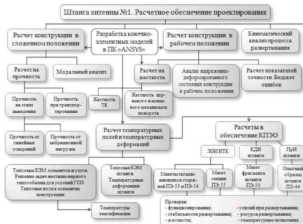
Рис. 4. Схема расчетного обеспечения проектирования
