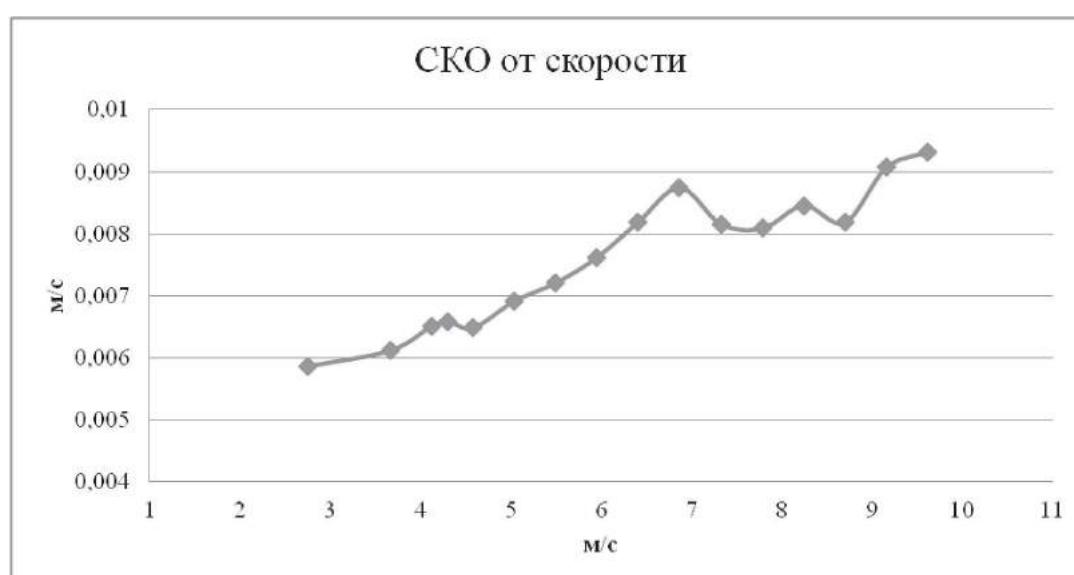
Рис. 2. График зависимости СКО измерения скорости от скорости
