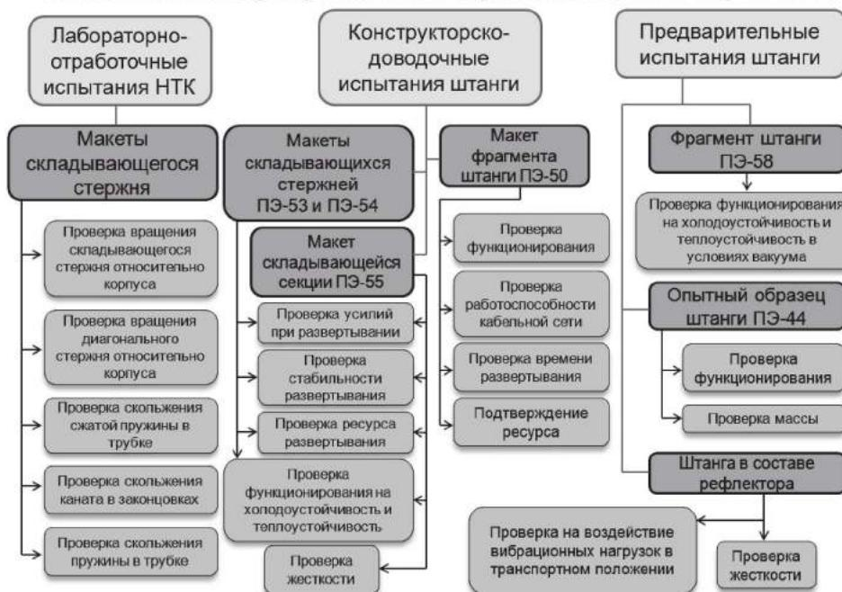
Рис. 8. Схема комплекса испытаний
