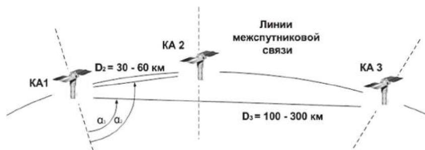
Рис. 1. Схема организации межспутниковой связи
