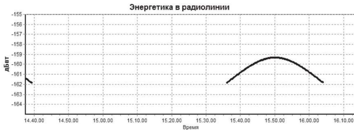
Рис. 3. График изменения мощности входного сигнала БАП на первом витке НО ИСЗ
