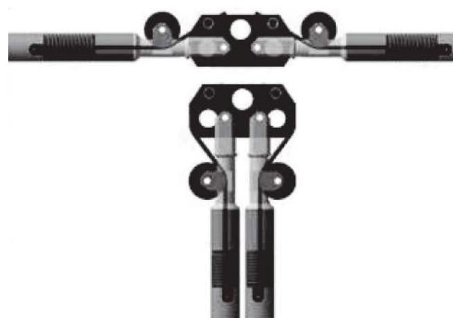
Рис. 2. Продольный стержень секции в развернутом и сложенном положениях
